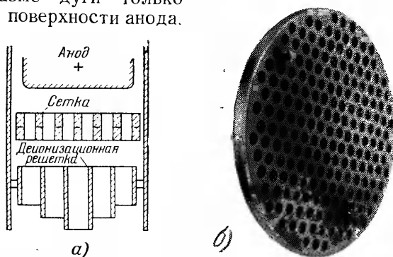
Фиг. 4-67. Анодно-сеточный узел ртутного вентиля при плоской сетке (а) и фотография сетки (б).
