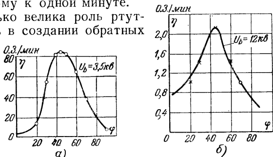
Фиг. 4-91. Частота обратных зажиганий при нефиксированном (а) и фиксированном (б) катодном пятне в функции угла установки отражателя.
