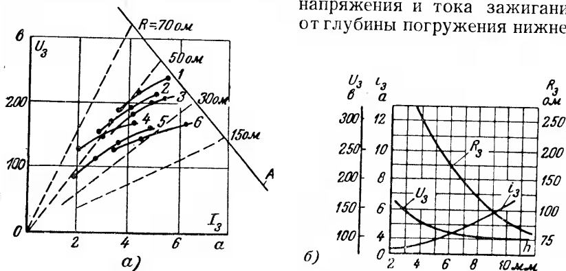
Фиг. 4-83. Вольтамперные характеристики зажигающего (а) и их зависимость от глубины погружения зажигающего (б).
